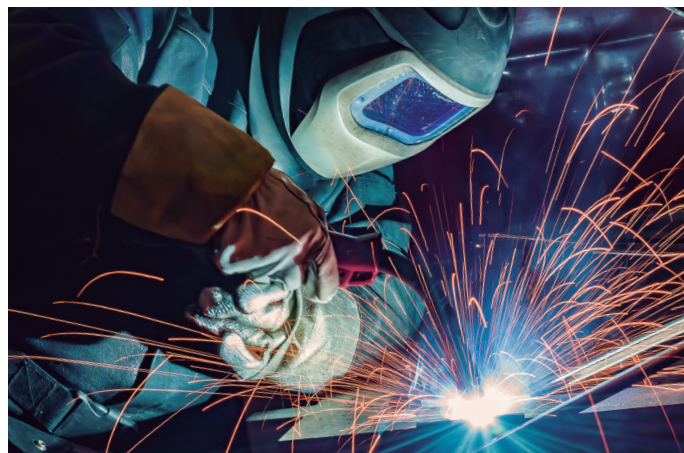
Figura 3. Soldadura de arco eléctrico.
